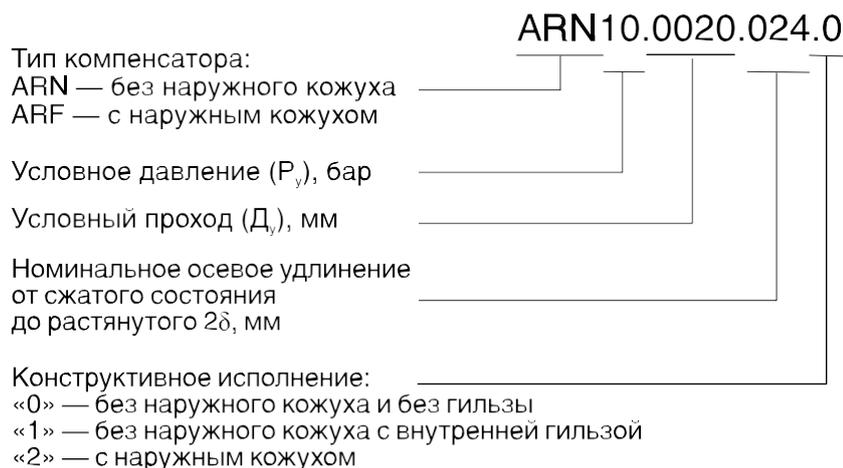
Предельная температура перемещаемой через компенсатор среды  $T_{\text{макс.}} = 300^\circ\text{C}$ .
